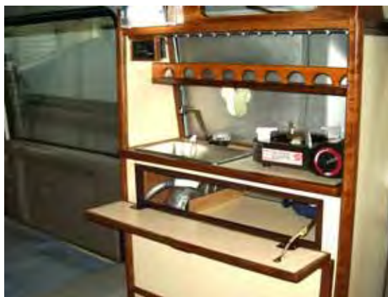
右側に調理台付きギャレーを置き内部に清水タンク（10L）をセット電動ポンプで 作動。排水タンクは車の下に取り付け、上側扉を開くとミニテーブルになり重宝、 ギャレー上部にはお洒落にLEDでライン照明にし、調味料棚も便利
