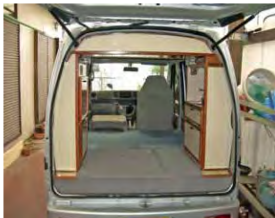
後部両側に最小幅の収納庫をセットし 快適な二名の就寝を可能にした
