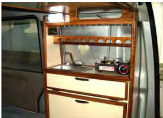
右側に調理台付きギャレーを置き内部に清水タンク（10L）をセット電動ポンプで 作動。排水タンクは車の下に取り付け、上側扉を開くとミニテーブルになり重宝、 ギャレー上部にはお洒落にLEDでライン照明にし、調味料棚も便利
