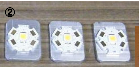
ダウンライト組込み用LED(1W電球色) ヒートシンクにクリスで固定する
