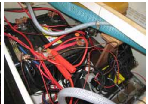
サブバッテリー(ディープタイプ2個搭載)
