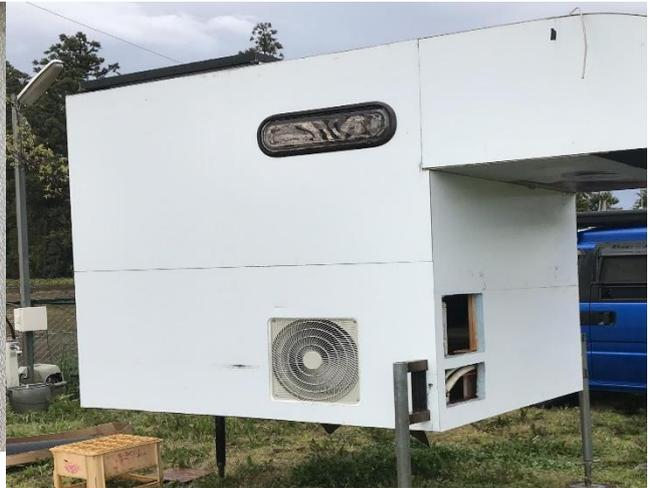
インバーター制御なので起動時の突入電力が無い事と極めて狭い空間を冷暖房するため一旦設定に達するとその後の消費電力が200W以下で済む為 晴れていれば ソーラーパネル サブバッテリー DCACインバーター のみで運転可能。
