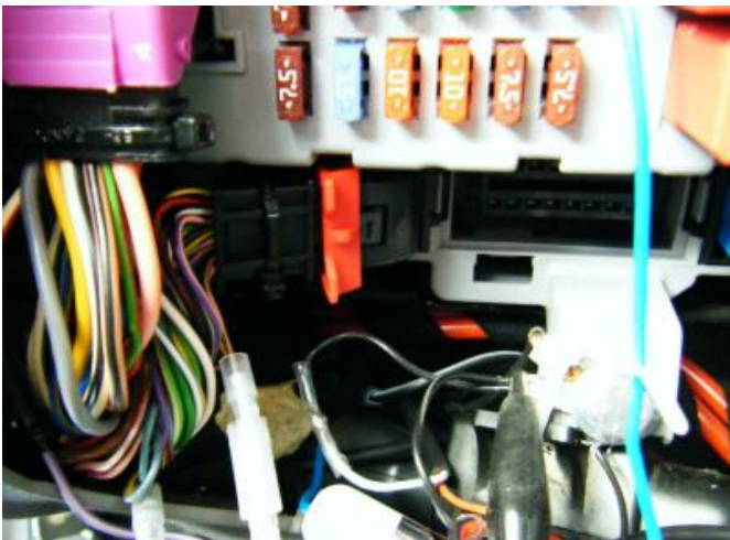
カバーを外すとヒューズ下のコネクタに 「ピンク/緑」の線があるので切断しル-へ
