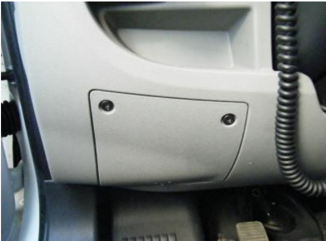
運転席側ウィッカ-取出しは、ヒューズがある カバーを外す
