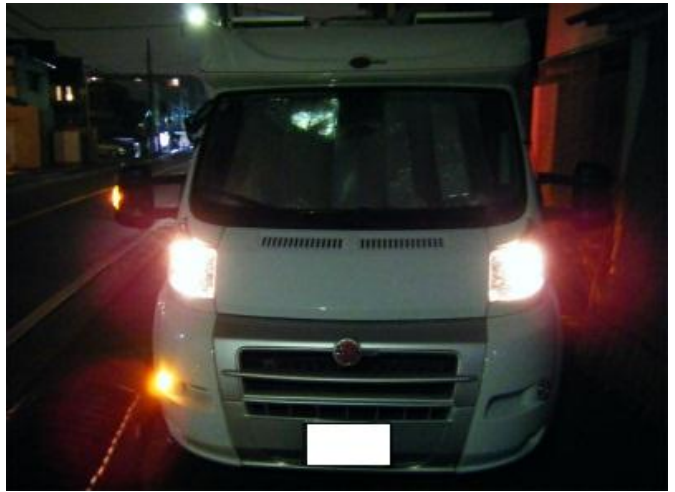
左側ウィンカー点灯時（右側スモール消灯）
