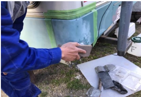
FRP も乾いたので仕上げの工程に。撫で撫で体験中 優しく 優しく! こちらも撫で撫で!
