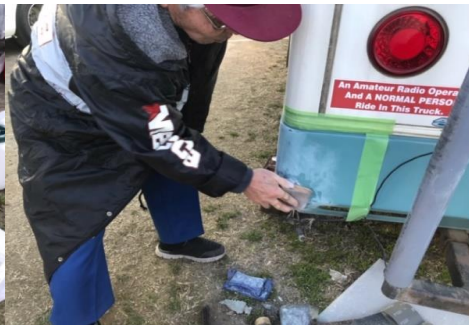
FRP も乾いたので仕上げの工程に。撫で撫で体験中 優しく 優しく! こちらも撫で撫で!
