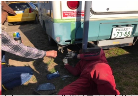
脱泡を徹底的にやり繊維内に泡を残さない。この作業は同時に余分な溶剤を絞り出す事にもなり 割れを防ぐ作用があります。」
